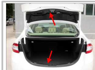
1.1 拆原车内饰件：拆下原车尾门内饰盖板（箭头），拆原车后踏板（箭头）
