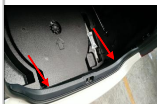
1.4 拆除好卡扣后，先将后踏板拆卸，然后再拆掉左右内饰板
