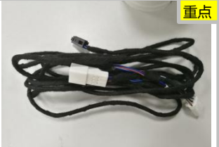
3.18 接门锁信号线：用我们配的转接线连接，再把我司转接线插头（箭头）插进上门锁
