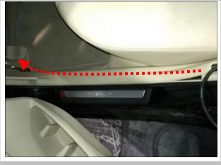
3.6 布正极线：把正极线从 B 柱内引至前门迎宾踏板隐藏（虚线）
