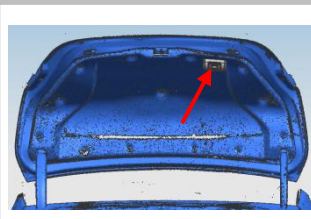
4.7 如图示意安装好开关按钮
