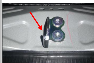
1.6 拆下原车下门锁
