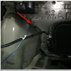
3.4 布正极线 将连接正极的线如图所示，通过尾箱后
