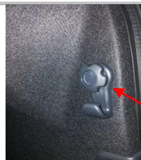
1.3 注意如图所示卡扣，需要将卡扣中心的圆形塑料往里按，然后整体拔出
