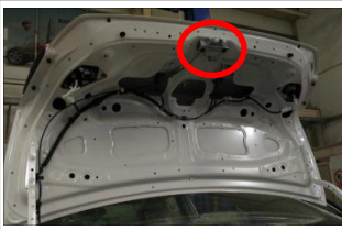
3.16 接门锁信号线：如图找到信号线大体位置，把信号线束延伸到尾门上门锁处
