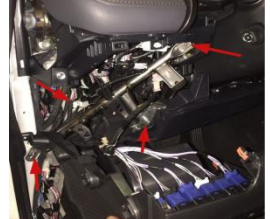
3.9 接正极：其次可以看到箭头的白色插头，但是需要把图中箭头的横铁螺丝松开，才能把其插头拔出来
