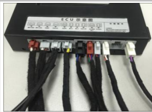
4.1 连接 ECU，把所有各部位线束插头连接好，最后把主线束插头对应安装到 ECU 上，
