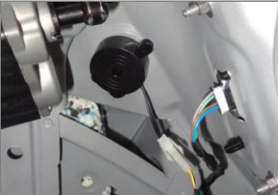
4.4 安装蜂鸣器：与 ECU 接头对接，并把蜂鸣器装在右侧装饰板内空旷处；（箭头）
