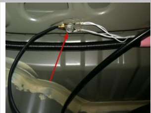
3.15 接负极：在尾箱内此处，松开原车螺栓不用拆下，负极铜片卡在螺栓上，再把螺母拧紧
