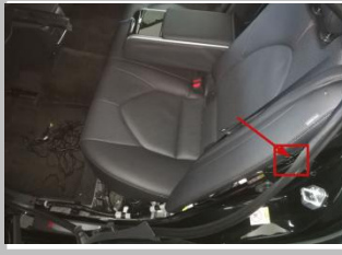
3.5 布正极线：把左 C 柱及迎宾踏板掀开，把正极线穿出（虚线）；注意线勿直接从座椅穿过，需在胶条内部隐藏
